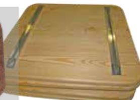
L'ossature du panneau est en bois lamellé collé où l'on vient intégrer notre tôle aluminium en 15/10ème. Les renforts à l'arrière de l'ossature sont en aluminium.
