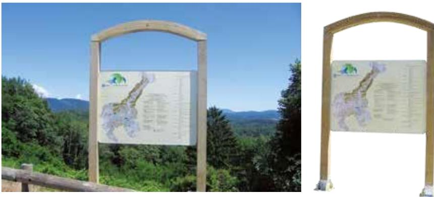
La gamme CALAO correspond à une gamme entièrement en ossature bois en lamellé collé cintré. Le cadre en aluminium correspond au profilé en aluminium de 40 mm. La section de l'ossature en bois est de 140 x 140 mm.
